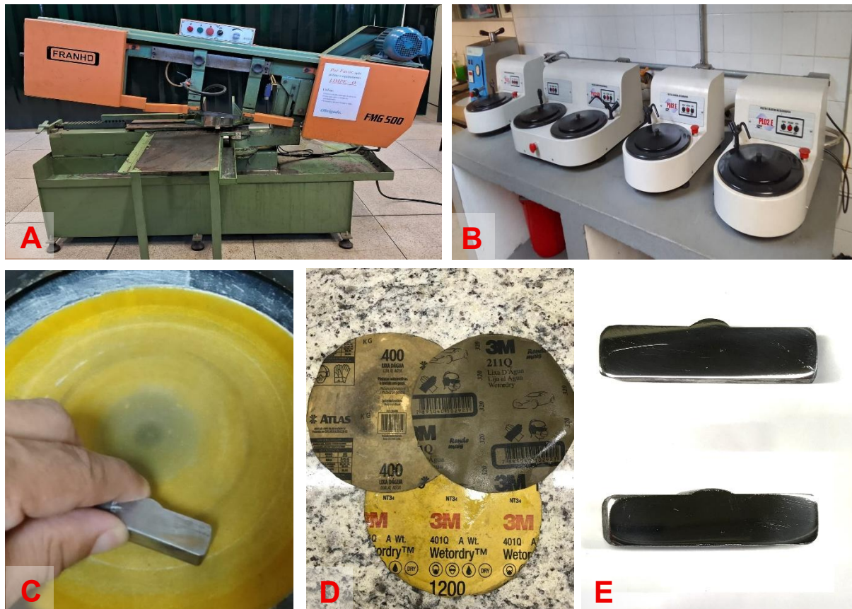
Figura 6 – Etapas da preparação metalográfica das amostras
