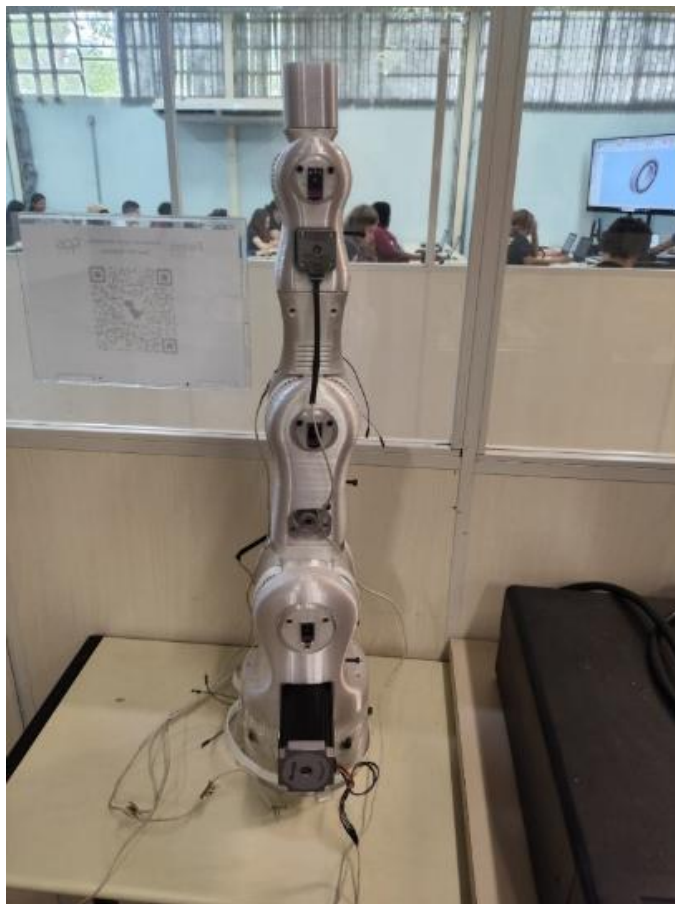
Figura 17 – BCN3D-MOVEO com estrutura atualizada, novas peças e sensor
