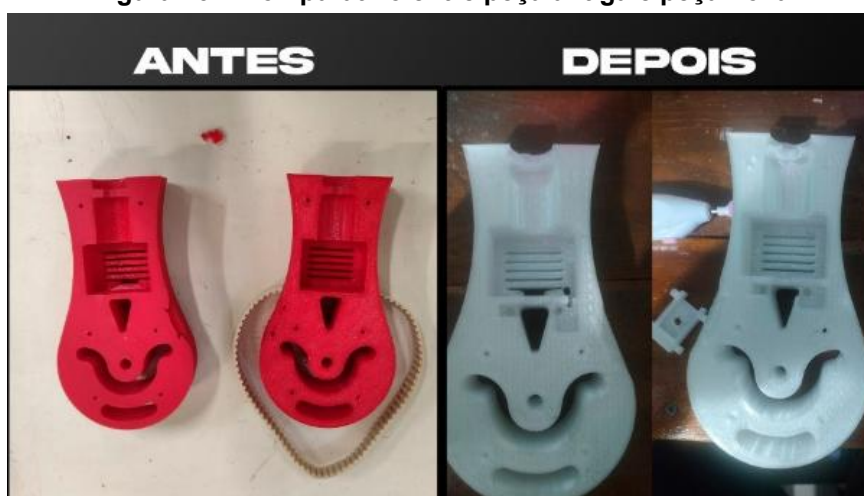
Figura 13 – Comparativo entre peça antiga e peça nova
