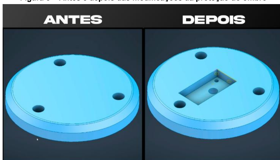
Figura 5 – Antes e depois das modificações da proteção do ombro
