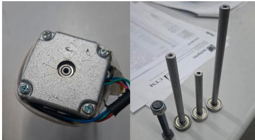
Figura 15 – Motor com furo M3 e eixos com furo M4
